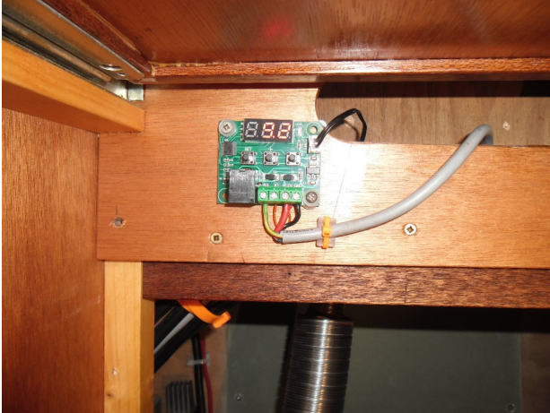
temperatuur sensor boven zwarte slang zwarte slang: luchtaanvoer kachel glimmende pijp: uitlaat
